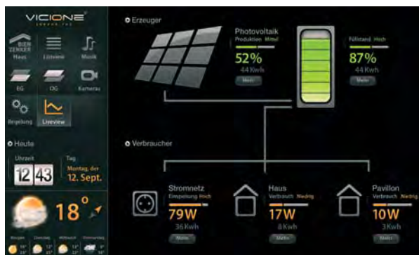
Visualisierung der Messergebnisse über die Gebäudeautomation
